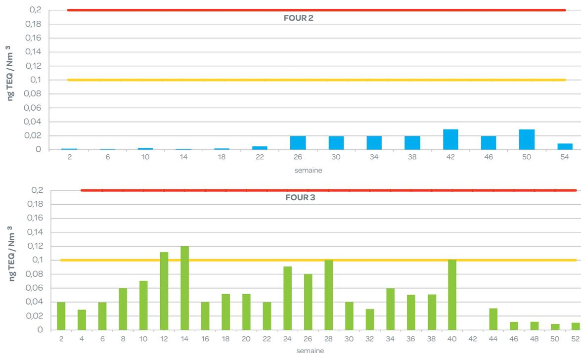
La hausse des quantités de dioxines sur la ligne 3 aux semaines 12 et 14 a entraîné la mise en place d'actions correctives suivantes : vérification des débits de charbon actif injectés avec augmentation de ce dernier ainsi qu'à une vérification de l'étanchéité des manches, des cymbales de by-pass au moyen d'un test fluorescent confirmant le bon état de celui-ci.
